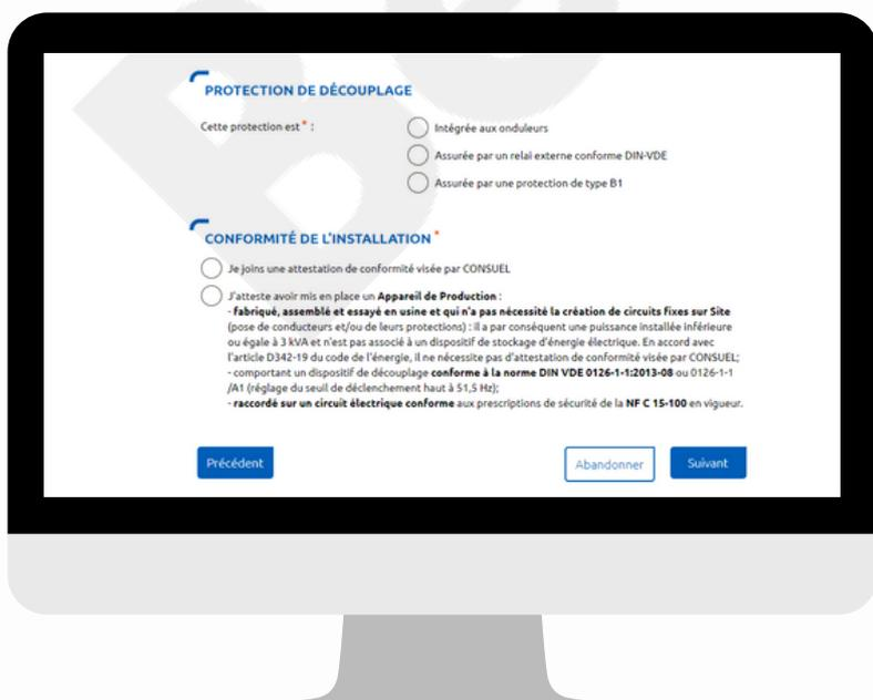
14 | Au niveau de la protection de découplage, sélectionnez "**Intégré aux onduleurs**". Ensuite remplissez la marque correspondant à l'onduleur, ici : **APsystems**, puis le modèle : **DS3-L** et pour finir indiquez le nombre d'onduleurs. (Pour Kit 1 à 2 panneaux : 1 onduleur | pour Kit 4 panneaux 2 onduleurs, 3 onduleurs pour le kit 6 panneaux et 4 onduleurs pour le kit 8 panneaux). Pour finir, cochez la deuxième case "j'atteste avoir mis en place un appareil de production".
